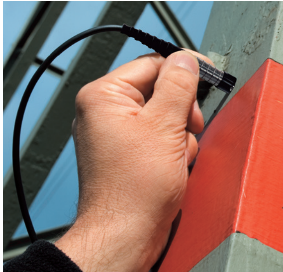
Измерение двухслойных покрытий с помощью датчика FDX13H
