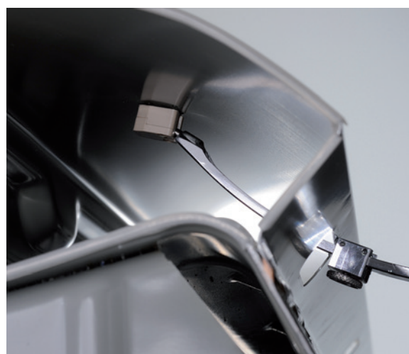
Кузов автомобиля в разрезе для демонстрации измерения толщины EPD – покрытия с помощью датчика
