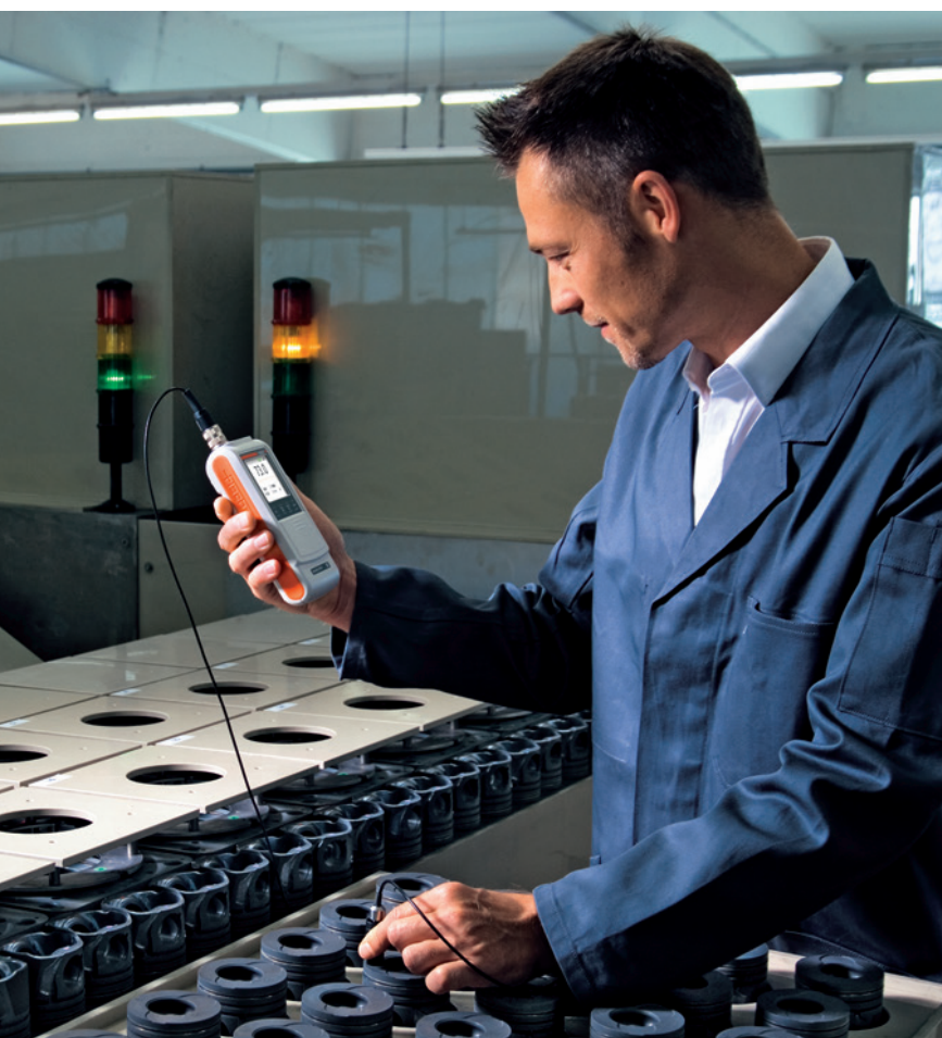
Контроль качества поршней двигателя после изготовления с помощью датчика FA13.3H
