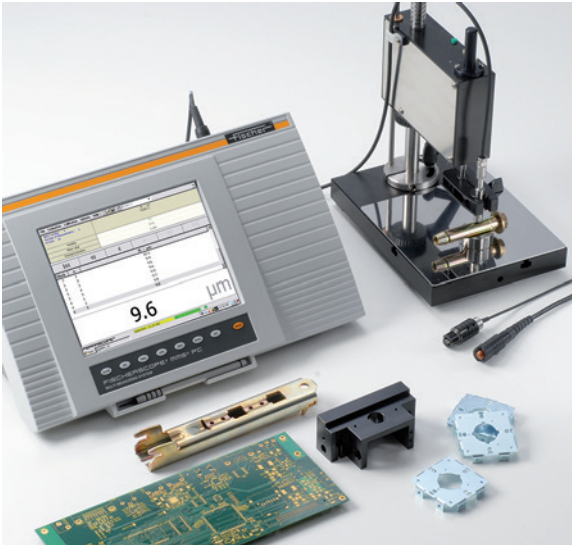
Измерение цинковых покрытий на винтах с помощью датчика FGAB1.3, установленного на штативе V12 MOT
