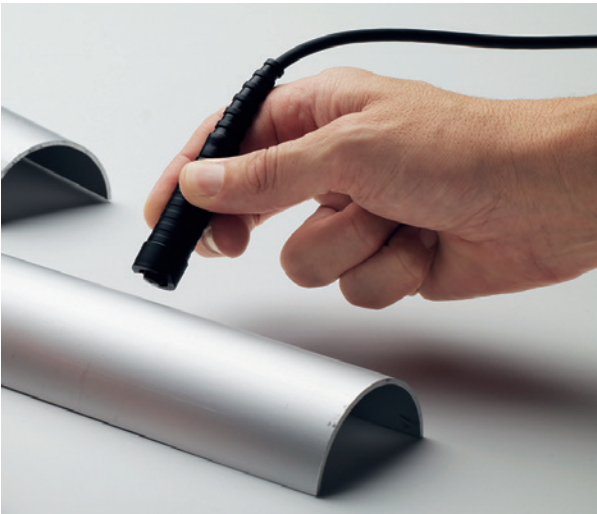
Измерение анодированных покрытий с помощью датчика FTD3.3 с компенсацией кривизны поверхности
