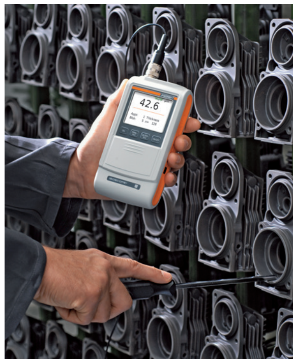
Измерение с помощью внутреннего датчика FA13.3-150
