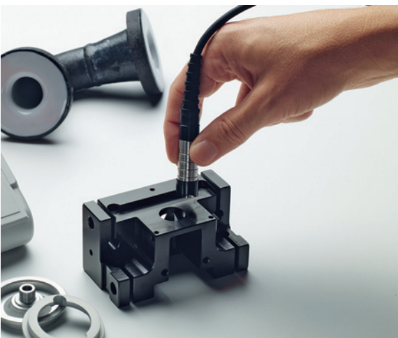
Измерение цинкопорошкового покрытия с помощью двухполюсного датчика V7FKB4
