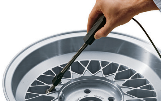
Измерение толщины слоя лака на алюминиевом ободе колеса с помощью датчика FAW3.3, вставленного в направляющее устройство
