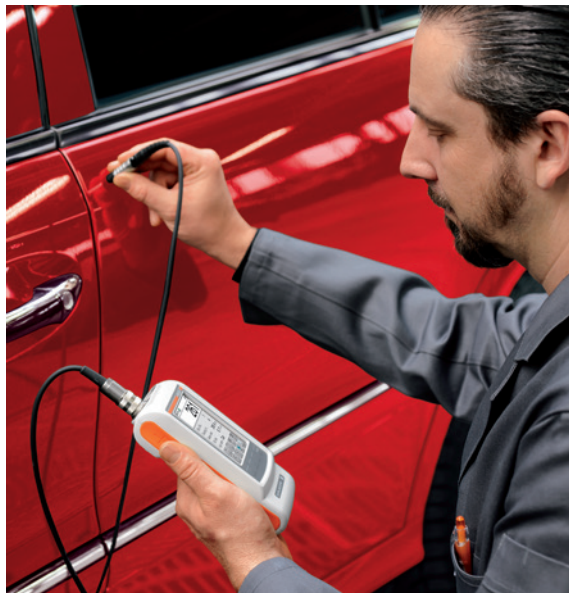
Измерение толщины слоя краски на корпусе автомобиля с помощью двойного датчика FD10
