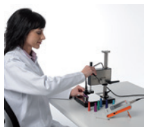
Измерение анодированных покрытий на гильзах с помощью датчика с компенсацией кривизны поверхности FTD3.3, установленного на штативе V12 BASE
