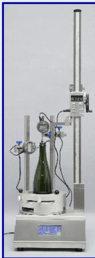
UBPT-3 с 3 измерительными головками (для зазора , перпендикулярности и высоты горлышка) и встроенными двойными автоматическими вычислителями
