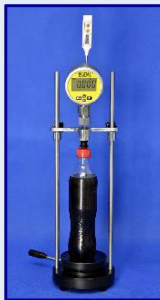
CO 2 EASY-D с цифровым индикатором давления
