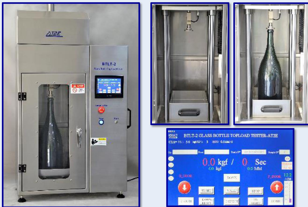
Испытательная камера и рабочий экран
