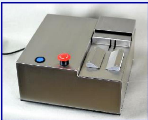
Отрезная пила для шовного соединения SS-1
