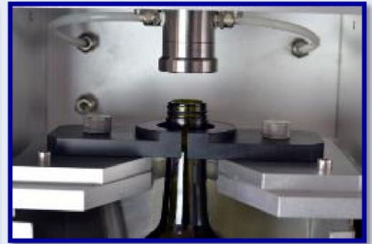
Система авто заполнения и зажимная
