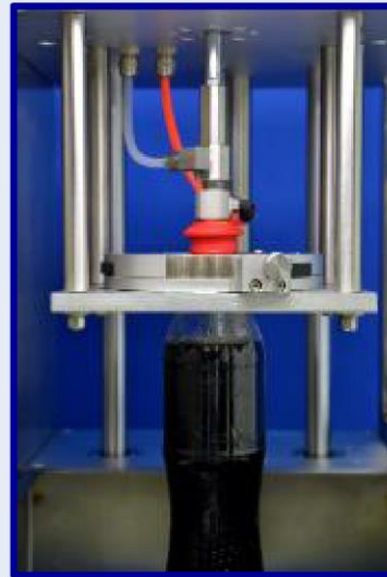
Автоматическое прокалывание и испытание с помощью патентной иглы АТ2Е
