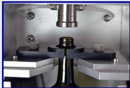
Система авто заполнения и зажимная
