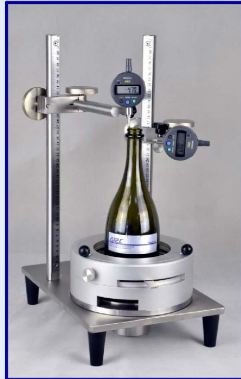
UBPT-2 с 2-мя измерительными головками (для зазора и перпендикулярности горлышка)
