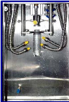
РАВТ с системой распыления горячей воды (дополнительно)
