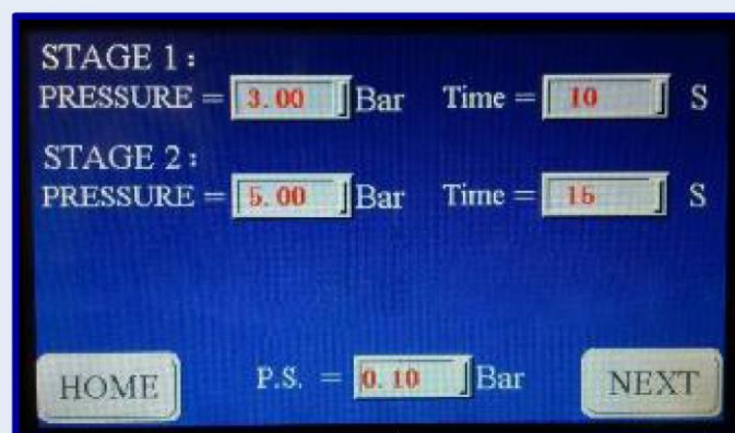
Интерфейс настройки давления и времени выдержки
