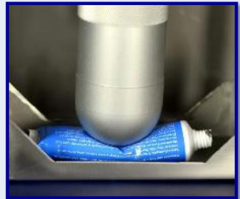
ТСТ-2 для испытания тьюбиков (с дополнительным приспособлением)
