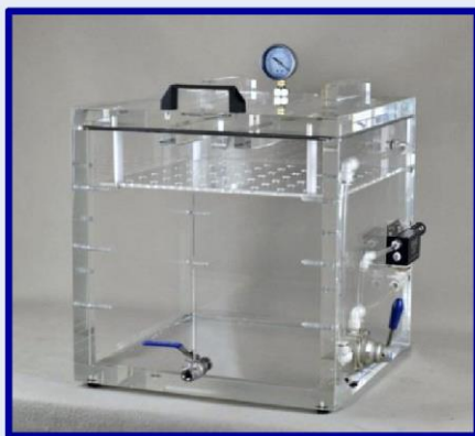
Камера с системой погружения
