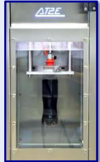
Автоматическое прокалывание и испытание с помощью патентной иглы АТ2Е
