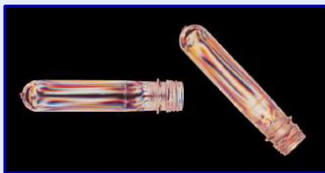
Параллельный вид и вид под 45^\circ заготовки с помощью PL-P
