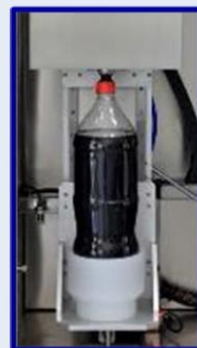
Автоматическая система прокалывания и панель управления
