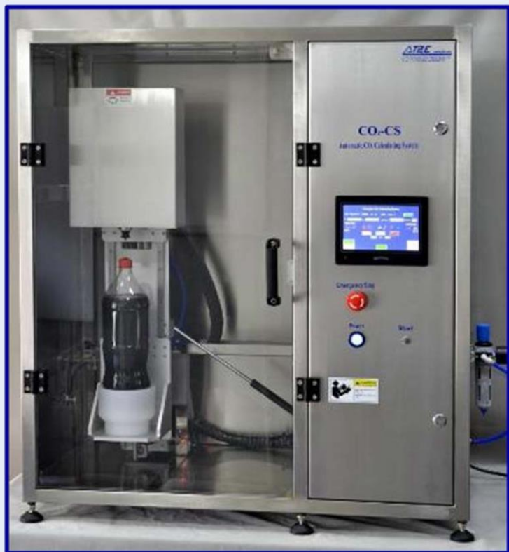
Автоматическая система прокалывания и панель управления
