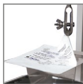
Испытание на отрыв упаковки контейнера
