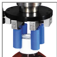
Тестирование крышек с функцией защиты от детей
